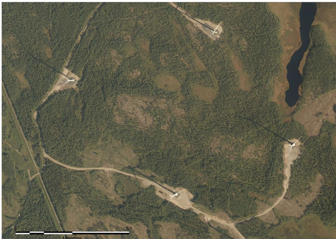
Bild 9. Exempelbild på verksam vindkraftspark. Servicevägar och resningsfält har byggts för vindkraftverken. I omgivningen av vindkraftverken och mellan dem har den tidigare markanvändningen bevarats oförändrad (Lantmäteriverket). Bilden är inte från Lasorområdet.
