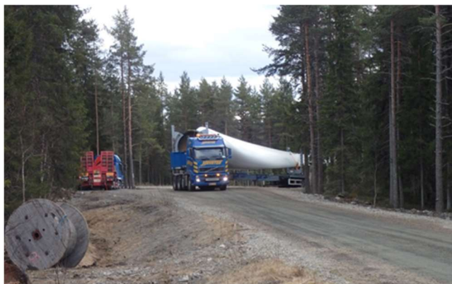
Bild 16. Till vänster ett exempel på byggnads- och servicevägar i vindkraftsparken. Vägarna används bland annat för transport av betong, grus och kraftverkskomponenter samt för servicekörningar i vindkraftsparkens driftsskede. Jordkabeln placeras i ett dikesschakt i kanten av vägen. Till höger delar till vindkraftverk som transporteras som specialtransporter. (Bilder: FCG).
