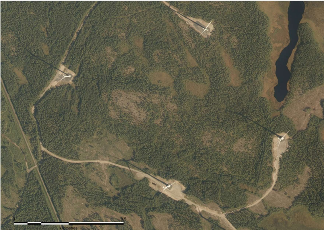
Kuva 9. Esimerkkikuva toiminnassa olevasta tuulivoimapuistosta. Tuulivoimaloita varten on rakennettu huoltotiet ja nostokentät. Tuulivoimaloiden ympäristössä ja välialueilla aikaisempi maankäyttö on säilynyt ennallaan (Maanmittauslaitos). Kuva ei ole Lasorin alueelta.
