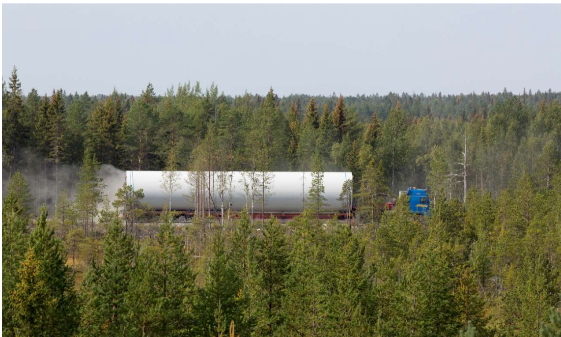
Kuva 25. Tuulivoimalan torniosien kuljetusta (Kuva: FCG).
