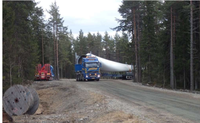
Kuva 16. Vasemmalla esimerkki tuulivoimapuiston rakennus- ja huoltotiestä. Teitä käytetään muun muassa betonin, soran ja voimaloiden komponenttien kuljetuksiin sekä tuulivoimapuiston käyttövaiheessa huoltoajoihin. Maakaapeli sijoitetaan ojakaivantoon tien reuna-alueelle. Oikealla tuulivoimalan osia kuljetetaan erikoiskuljetuksina. (Kuvat: FCG).
